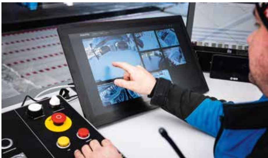
Sofern die Anlage stoppt, kann der Mitarbeiter sie in der Station manuell wieder aktivieren. Die Kontrolle der Bahn ist jedoch auch dezentral möglich.
